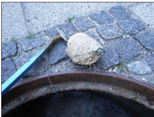
Figur 2.6. Giftfri indikatorblok med rottegnav.
