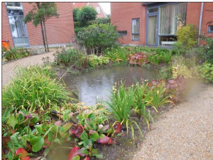
Figur 5.1. Et regnbed, hvor regnvandet opmagasineres mens det synker ned i jorden.
