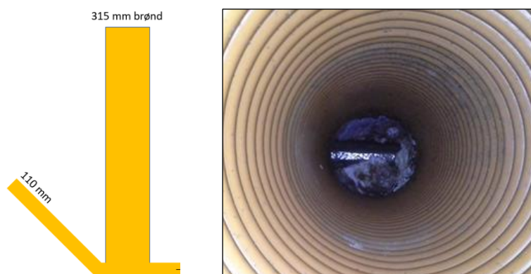
Figur 2.3. Ved brønde med sidetilløb kan stort fald på sidetilløbet give tilstopning ved en rottespærre i udløbet af brønden.
